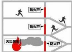
防火戸が正しく使用されていると… 炎、煙の拡大を防ぎます
