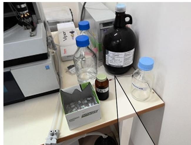
×引火点の低い薬品の移し替え時に静電気対策を取られていない
