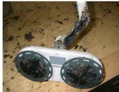
写真3 電動モップの焼損状況
