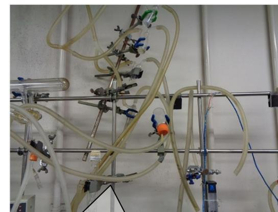
×水素ガスを使用しているがガス漏れ警報器を設置していない
